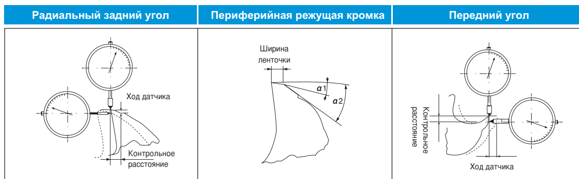
Рис. 6. Установка индикатора для проверки
